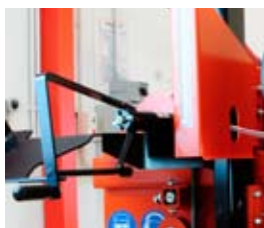
Точное и быстрое позиционирование пилящей головы
