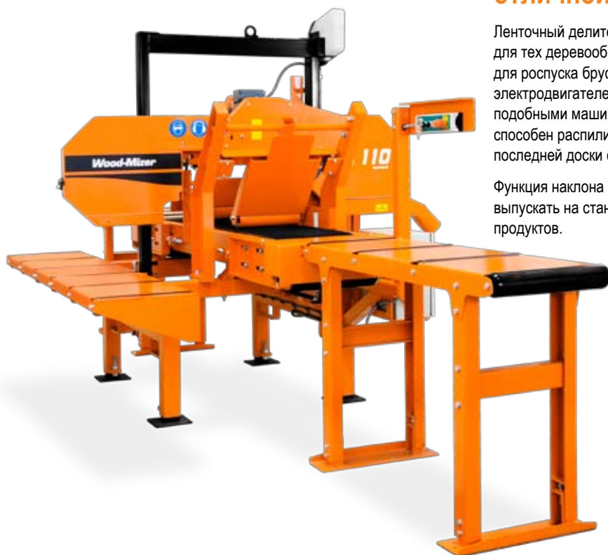
На фотографии: делительный станок HR110 с электрическим двигателем
